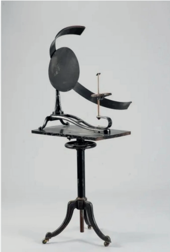
Oftalmologisk bord med bueperimeter fra Rikshospitalets øyeavdeling, antatt brukt 1900–1930. Foto: Håkon Bergseth/ Teknisk museum
